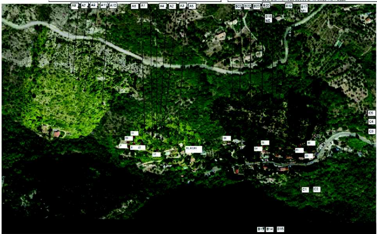
Illustration n°24 : localisation des instabilités rocheuses (points noirs et des blocs éboulés (étoiles rouges) (annexe A3 de l'étude SOL SYSTEMES)
